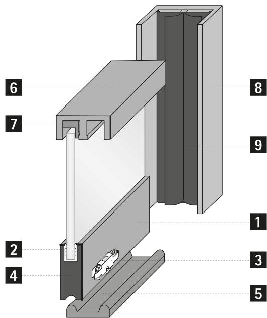
Základní varianta s celoobvodovým rámovým profilem
